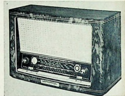
Abb. 6. Ansicht des Empfängers; unterhalb der Drucktasten ist die Bedienungswippe für den Schnellauf und den automatischen Suchlauf sichtbar
